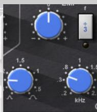
3. sección de ecualización de frecuencia media baja (perillas azules) rango de 200 Hz - 2,5 kHz. Q es continuamente ajustable de 0,1 a 3,5. Ganancia varía de  $\pm 20$  dB cuando Q se establece en 3,5, a  $\pm 15$  dB cuando Q se fija en 0,1. El botón  $\div 3$  divide la frecuencia seleccionada por tres (por ejemplo, si ha seleccionado una frecuencia central de 300 Hz, al pulsar el  $\div 3$  botón dará lugar a una frecuencia de 100 Hz.)
