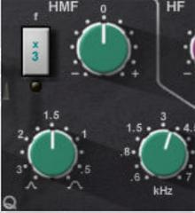
4. Sección de alta frecuencia media de EQ (perillas verdes) Alcance de 600 Hz - 7 kHz. Como en la sección EQ LMF, Q es continuamente ajustable de 0,1 a 3,5. Ganancia varía de  $\pm 20$  dB cuando Q se fija en 3,5, a  $\pm 15$  dB cuando Q se fija en 0,1. El botón x3 le permite multiplicar la frecuencia seleccionada por tres.
