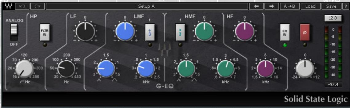
1. Filtro de paso alto (perillas blancas a la izquierda) 18 dB / octava, 16 Hz - 350 Hz. Filtro de entrada / salida de conmutación, con indicador.
