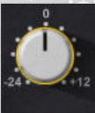
8. Salida de Maestro (a la derecha) atenuador de salida principal controla la producción general del procesador.
