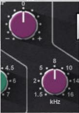
5. Sección de alta frecuencia de EQ (perillas púrpuras) intervalo de 1,5 kHz - 16 kHz. Rango de ganancia  $\pm 17$  dB, filtro estante o shelving.
