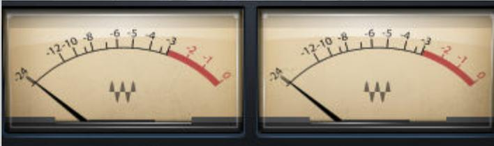
8) **MEDIDOR (METER)** muestra los valores de pico de la señal de salida dBFS.
