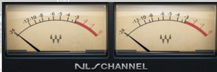
10) **Medidor (METER)** muestra los valores de pico de la señal de salida en dBFS.
