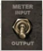
**MEDIDOR interruptor** activa el seguimiento del medidor entre los modos de entrada y de salida
