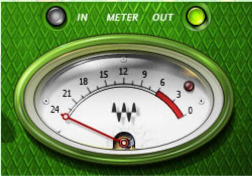
**Sección del medidor** El conmutador Meter cambia la monitorización del medidor entre los modos de entrada y salida. El clip El LED se enciende cuando los niveles alcanzan 0 dBFS; Haga clic para restablecer.
