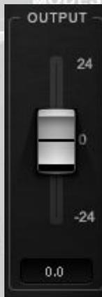
**Salida** Ajusta el nivel de salida de Cobalt Saphira. Su nivel de salida no cambiará cuando cargue un preset.
