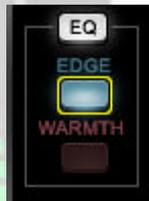
**Edge EQ** Al hacer clic en este control le permitirá controlar un ecualizador de 4 bandas que se aplica después de que Los armónicos se añaden a la señal pero antes de que se mezcle junto con la señal directa. El EQ de 4 bandas tiene las siguientes propiedades:
