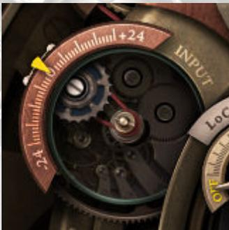
Este control ajusta el nivel de entrada antes de cualquier procesamiento. Use este control para ajustar el nivel de entrada para que el LED de sensibilidad muestre los niveles óptimos. Le recomendamos hacer el ajuste de la entrada en la parte más alta de su pista vocal.
