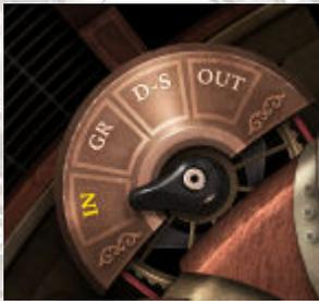
El interruptor del medidor conmuta monitoreo entre entrada, GR (reducción de ganancia), DS (DeEsser) y Modos de salida. El LED CLIP se ilumina cuando los niveles llegan a 0 dBFS. Haga clic para Reiniciar.
