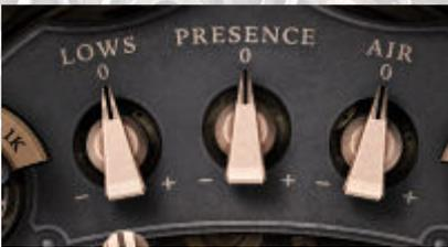
BV: "La sección de EQ tiene tres bandas de frecuencias que en repetidas ocasiones por defecto quedan bien con la voz fija. Ellas están diseñadas para un impulso en EQ, pero también puede ser utilizado para cortar si es necesario.
