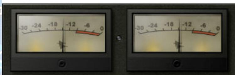
El medidor de la API 560 muestra el nivel de salida en dBFS. El Clip LED, situado entre los dos metros, se ilumina cuando la señal de salida excede 0dBFS.
