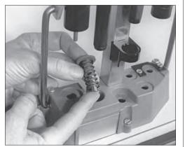
**2** Install the primer punch, spring and primer quide into STATION 2.
