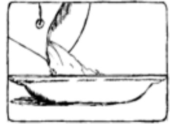
Pour Plaster Into Mold
