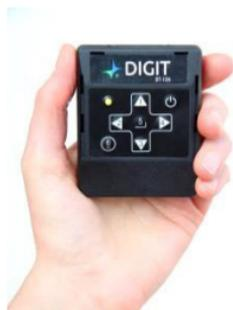
Das AirTurn DIGIT BT-106 ist ein Kombinations-Bluetooth-Sendeempfänger, der in einer Vielzahl von Möglichkeiten verwendet werden kann. Es bietet eine Tastatur mit sechs Schaltern. Die Schalter werden auch
