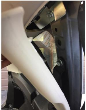
**Step 4**Remove the 10mm bolt.
