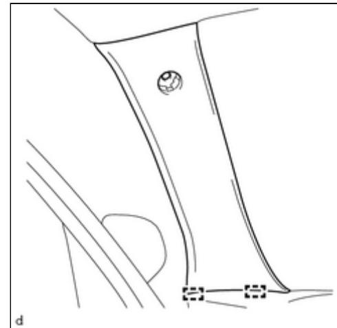
(d) Detach the 2 guides to remove the front pillar garnish LH.
