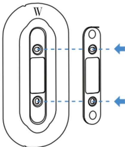
4. Pasa los cables a través de la abertura como se muestra a continuación. Monta la placa de pared junto con la placa posterior en la pared utilizando los tornillos y los anclajes de pared proporcionados (el tamaño de la broca es de 1/8 de pulgada).
