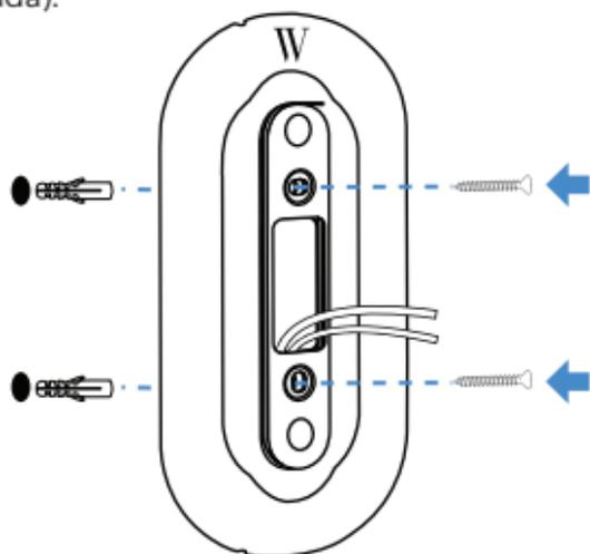
5. Conecta los cables al timbre. A continuación, fija el timbre a la placa de pared como se muestra en la imagen.
