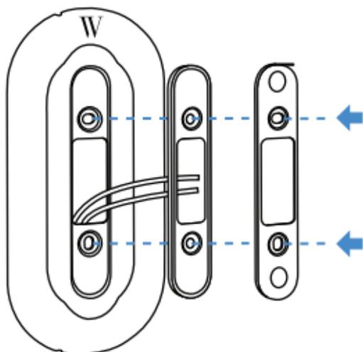
3. Fija y atornilla la placa trasera del timbre en la cuña del timbre junto con la placa de pared.
