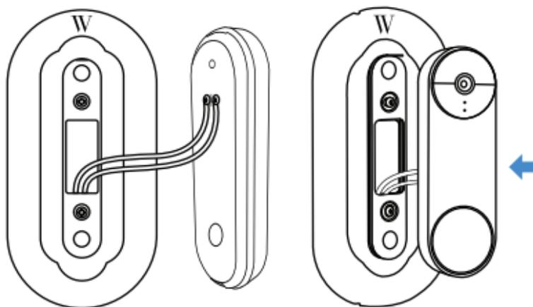
6. Fija el timbre con el tornillo que viene con el timbre. Enciende la alimentación y comprueba la aplicación para asegurarte de que el timbre se haya instalado correctamente.
