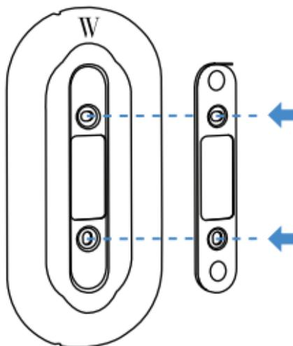
4. Führen Sie die Drähte wie unten gezeigt durch den Ausschnitt. Befestigen Sie die Wandplatte zusammen mit der Rückwand mit den mitgelieferten Schrauben und Dübeln an der Wand (die Bohrergröße ist 1/8 Zoll).
