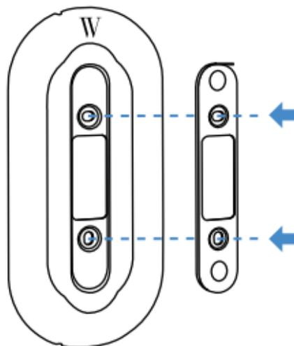
4. Faites passer les fils à travers la découpe comme indiqué ci-dessous. Fixez la plaque murale ainsi que la plaque arrière au mur à l'aide des vis et des ancrages muraux fournis (la taille du foret est de 1/8).
