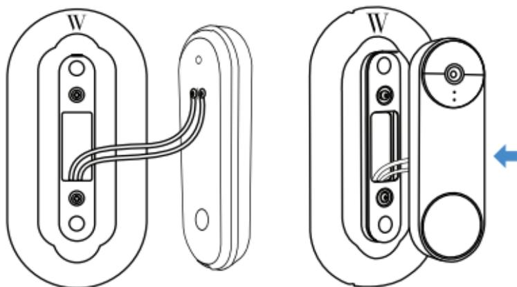
5. Fija el timbre con el tornillo que viene con el timbre. Enciende la alimentación y comprueba la aplicación para asegurarte de que el timbre se haya instalado correctamente.
