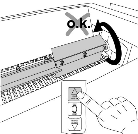
**D Dreht die Flügelwelle in die falsche Richtung → Drehfeld von einer Elektrofachkraft ändern lassen.**
