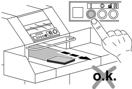
**D Falsche Förderrichtung → Drehfeld von einer Elektrofachkraft ändern lassen.**
