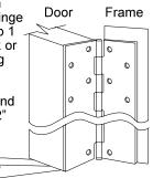
ALL HOLE LOCATIONS ON HINGE LEAF MUST BE FASTENED TO FRAME FOR PROPER OPERATION. FAILURE TO INSTALL ALL FASTENERS WILL VOID WARRANTY AND UL FIRE LABEL LISTINGS.
