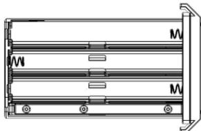
De nouvelles piles, alcalines ou au lithium, de type 'AA' doivent être insérées en respectant l'orientation indiquée sur le compartiment. Comme avec la plupart des appareils électroniques, l'orientation négative (-) des piles devrait être contre les ressorts. Ne pas insérer les piles incorrectement endommagera l'appareil.
