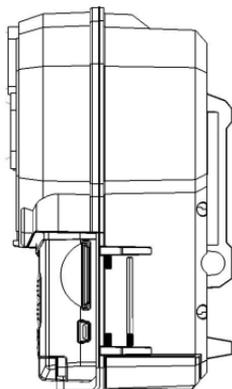
Lorsque la carte a été complètement enfoncée, il y aura une résistance notable, car le mécanisme de verrouillage de source s'active pour mettre la carte SD en attente.
