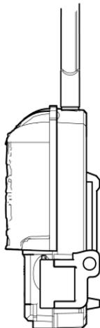
Lorsque la carte a été complètement enfoncée, il y aura une résistance notable, car le mécanisme de verrouillage de source s'active pour mettre la carte SD en attente.
