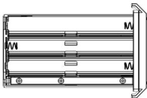
De nouvelles piles, alcalines ou au lithium, de type 'AA' doivent être insérées en respectant l'orientation indiquée sur le compartiment. Comme avec la plupart des appareils électroniques, l'orientation négative (-) des piles devrait être contre les ressorts. Ne pas insérer les piles correctement endommagera l'appareil.
