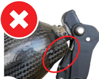
Fig. 13 Malpositioned Flexion Stop
