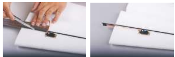
8. Install the left aileron servo.
