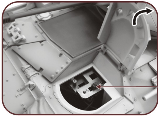
电源开关 Power switch
