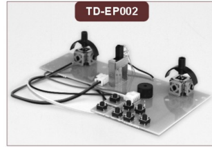
发射板(2.4GHz) Transmitting board(2.4GHz)
