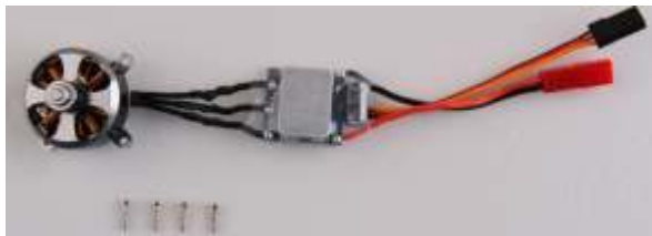
25. Motor: AS2204 KV 1700 ESC: 10A
