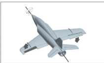
飞行中副翼右转 —— 舵面修正图示
