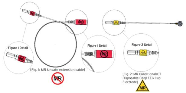
Evitar la exposición prolongada o repetida a sustancias que contengan acetona o acetato de etilo. Estos disolventes pueden dañar el electrodo y pueden conducir a un fallo prematuro del producto.
