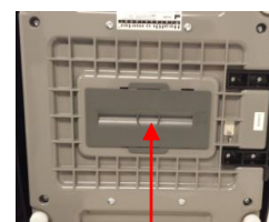
Compartimento de las baterías
