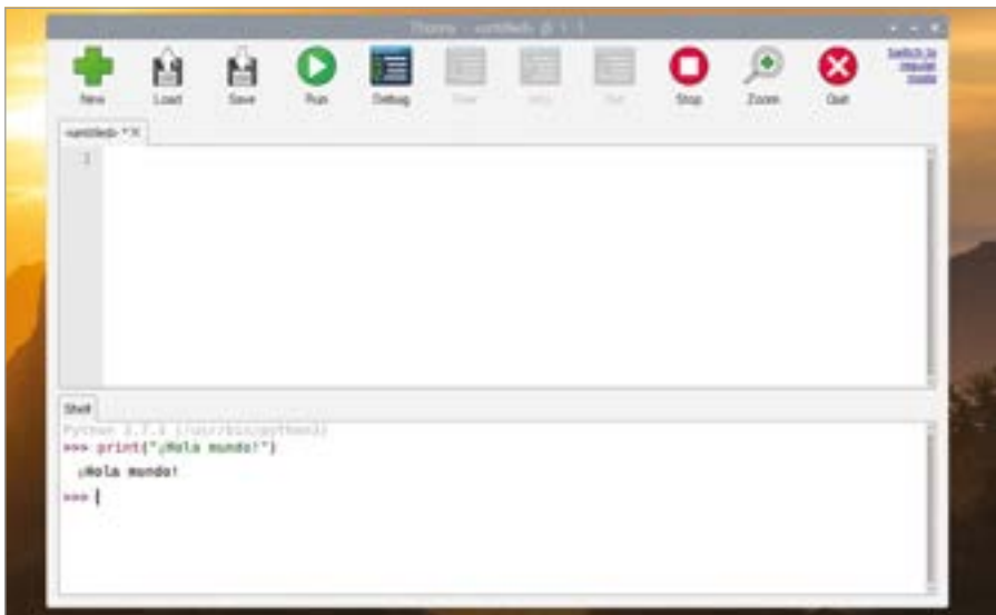
▲ Figura 5-1: Python muestra el mensaje '¡Hola mundo!' en el área de shell
