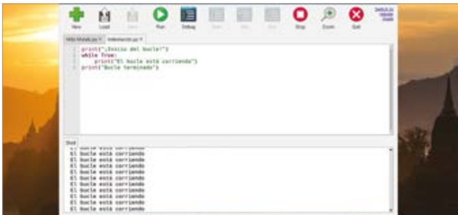
▲ Figura 5-4: Un bucle infinito se ejecuta constantemente hasta que detienes el programa
