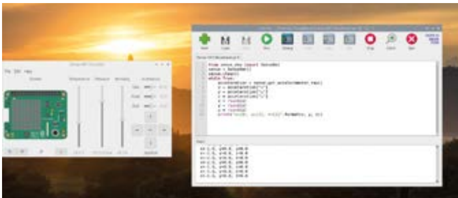
▲ Figura 7-27: Las lecturas del acelerómetro se redondean al número entero más cercano
