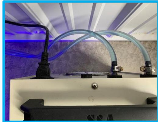
**IMPORTANT – FROM THIS STEP FORWARD - IF THE MACHINE IS ON, THEN THE CHILLER NEEDS TO BE ON. ALWAYS LEAVE THE CHILLER SWITCH TO THE “ON” POSITION AS THE POWER IS DERIVED FROM THE PRINTER ITSELF. THE CHILLER WILL TURN OFF WHEN THE POWER TO THE PRINTER IS TURNED OFF. THE CHILLER WILL BEEP MULTIPLE TIMES WHEN TURNED ON.**
