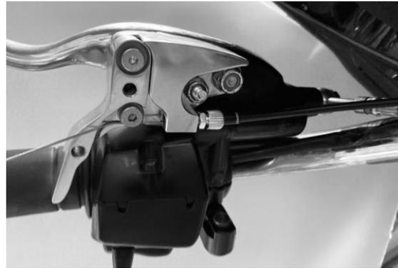
**FIGURE 49 | SAFETY LEVER INSTALLED**
