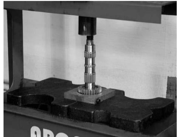
FIGURE 13 | PRESSING OFF 5<sup>TH</sup> COUNTER
