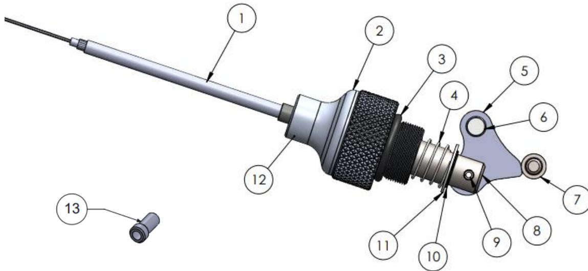
FIGURE 7 | SAFETY LOCK OUT PLUNGER ASSEMBLY
