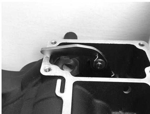
FIGURE 11 | LIFT THE PAWL ARM ONTO THE GASKET
