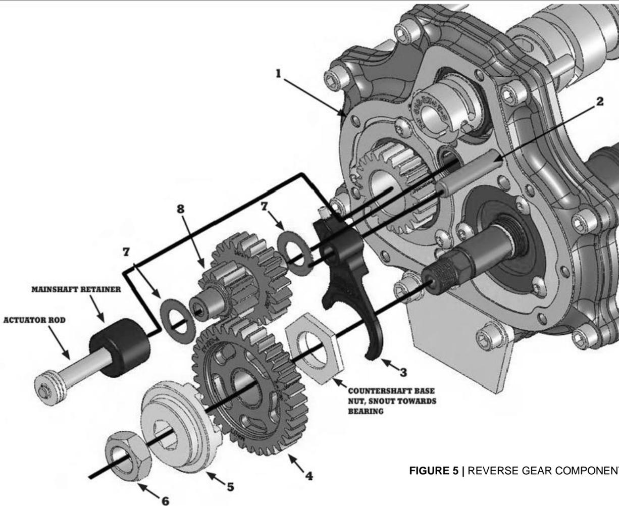
FIGURE 5 | REVERSE GEAR COMPONENTS
