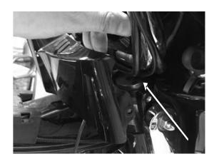
FIGURE 47 | TOURING DASH PULLED BACK THE DASH
