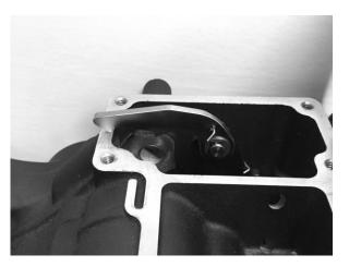
FIGURE 11 | LIFT THE PAWL ARM ONTO THE GASKET
