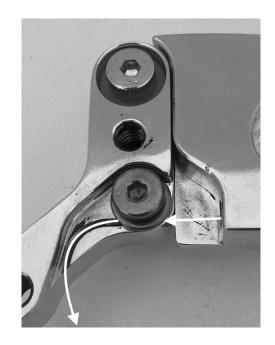
FIGURE 50 SAFETY CABLE ROUTING THUMB LEVER DETAIL
