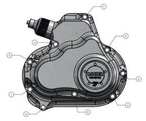
FIGURE 38 | TORQUE SEQUENCE FOR SIDE COVER
