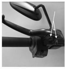
FIGURE 48 | SAFETY LEVER MOUNT POSITION
