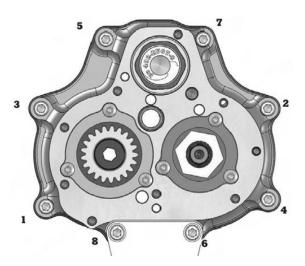
FIGURE 27 | BEARING DOOR TORQUE SEQUENCE
