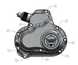
FIGURE 41 | TORQUE SEQUENCE FOR SIDE COVER
