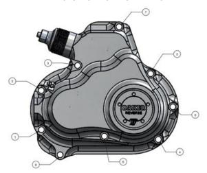
FIGURE 35 | TORQUE SEQUENCE FOR SIDE COVER
