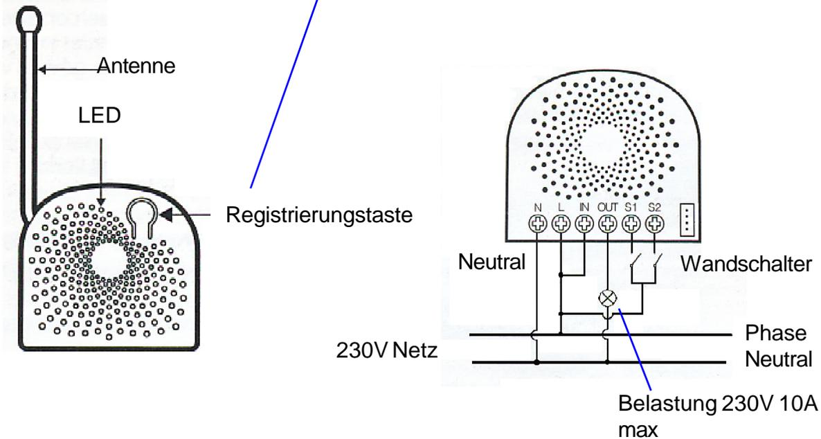
Fügen Sie mit der Registrierungstaste das AEOTEC-008-Modul zur VESTA-Zentrale hinzu.
