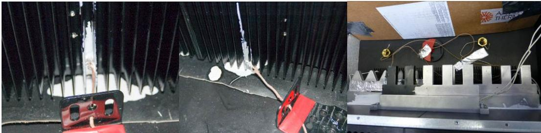
**Figura 9:** disposizione delle termocoppie all'interno dello chassis 3
