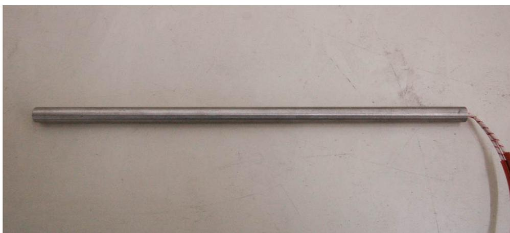
**Figura 5:** resistenza montata all'interno della piastra scaldante
