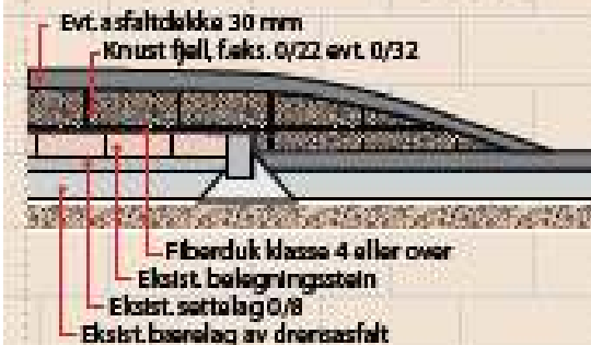
Midlertidig beskyttelse av belegningsstein
