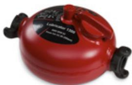
El lubricador 1300 de CP (modelo para la UE) y el lubricador 43 (modelo para EE UU) emplean un eyector que garantiza el control de la lubricación. La toma está intencionalmente curvada para garantizar el suministro de aceite independientemente de la posición del lubricador. Muchos lubricadores más baratos de la competencia no trabajan si se invierte su posición, por ello debe utilizar siempre lubricadores originales de CP para mantener la máquina correctamente lubricada.
