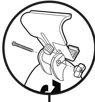
Montieren Sie die obere Handyhalterung mit der mitgelieferte Schraube und Flügelmutter.
