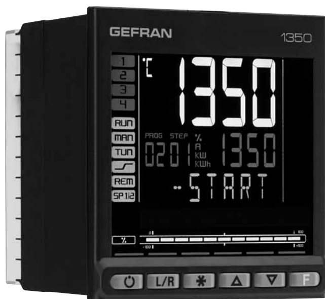
Dimensions 96 × 96 × 80 mm (1/4 DIN)
