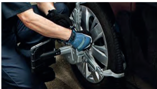
AC400 l'ancora a contatto gomma per non rischiare di danneggiare il cerchio.
