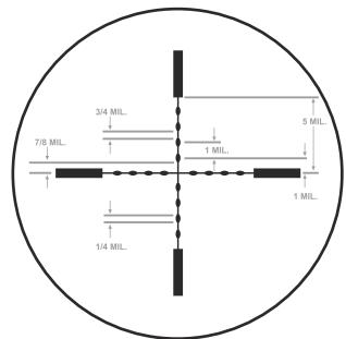
1 mil (millirad) équivaut à : 3,6 pouces à 100 yards ou 36 pouces à 1,000 yards, ou 10 cm à 100m, ou 1m à 1,000m. 1 millirad (1 mil) = 0,001 d'une distance = 3,4377 MOA
