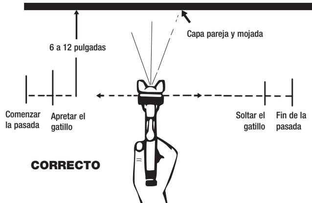
Sostenga la pistola de 6 a 12 pulgadas de distancia de la superficie, según el material que se use y la presión de atomización. Para obtener un acabado uniforme, trasape cada pasada sobre la pasada precedente, asegurándose de que el rociado salga suave y mojado.
