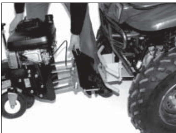
5) Die Anbauehrmaschine anheben und die Schnellkupplung einhängen.
