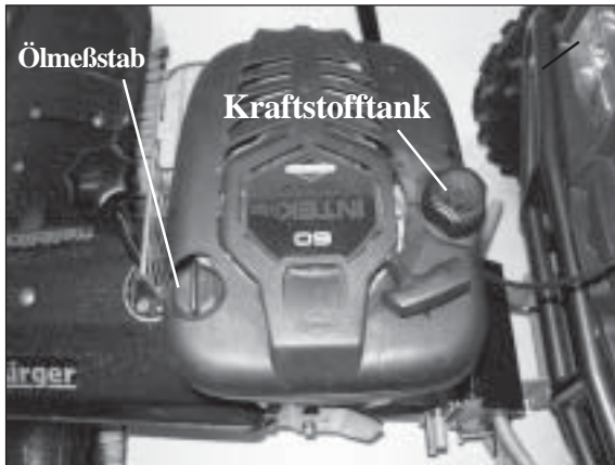
1) Kraftstoff- und Öltank beim B&S-Motor
