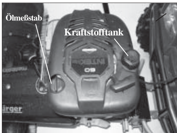
1) Kraftstoff- und Öltank beim B&S-Motor
