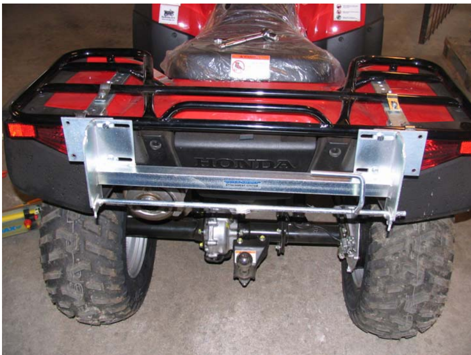
Trin 10: Færdig monteret Quick Smart Adapter set bagfra.
