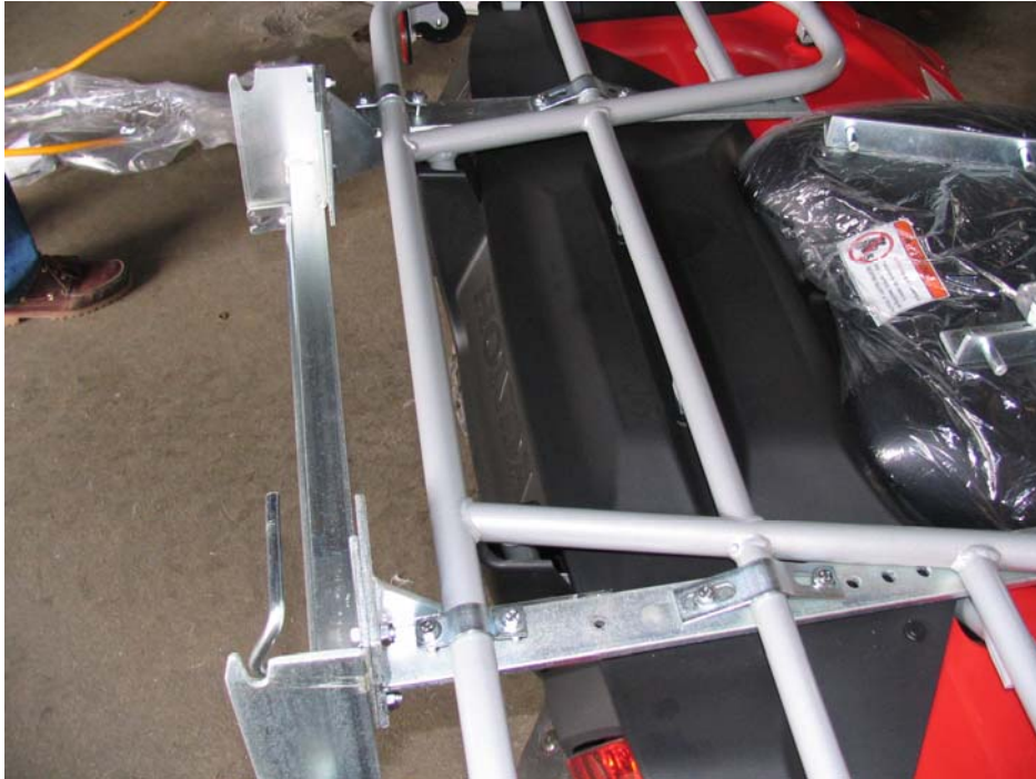
Trin 9: Færdig monteret Quick Smart Adapter
