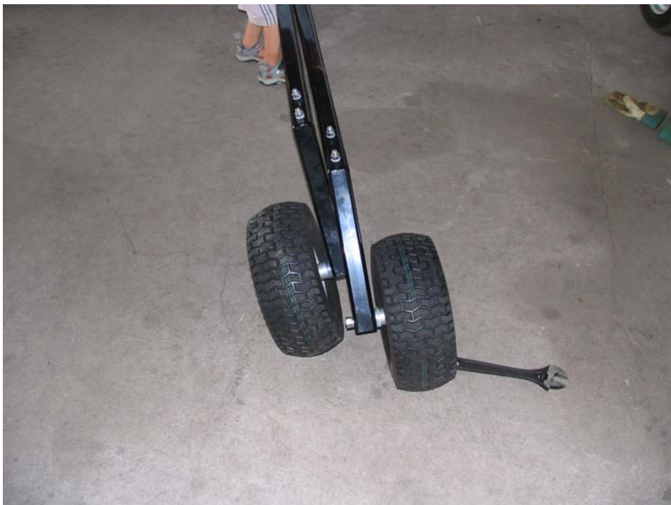
Trin 4: Monter de to baghjul som vist på bærerammen. De to baghjul skal vende udad. Monter derefter de to drejelige forhjul
