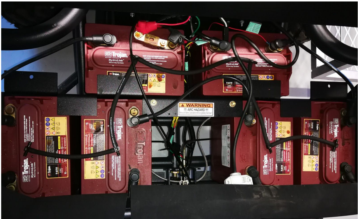
Billede 4-5: Sammenkobel alle hætterne med gummislangen som vist på billederne
