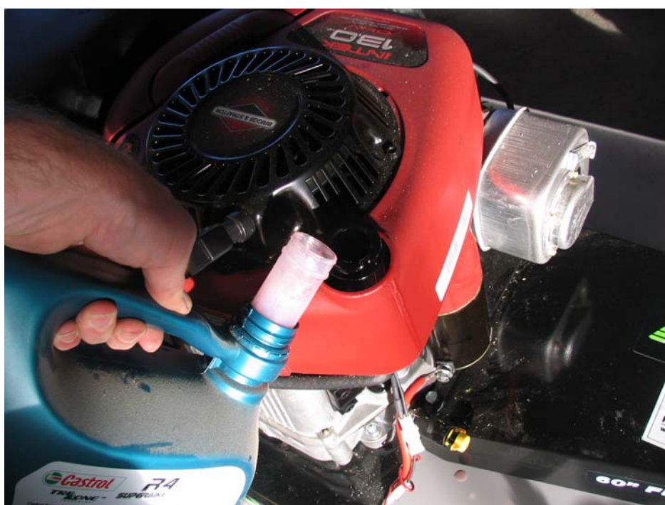
Trin 10: Påfyld Motorolie (SAE 30) på motoren før du starter. Se den medfølgende Briggs & Stratton manual. Fyld benzin (95 blyfri) i tanken.
