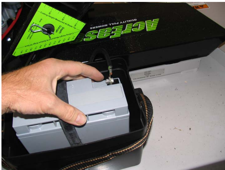
Trin 9: Tilslut plus polen på batteriet
