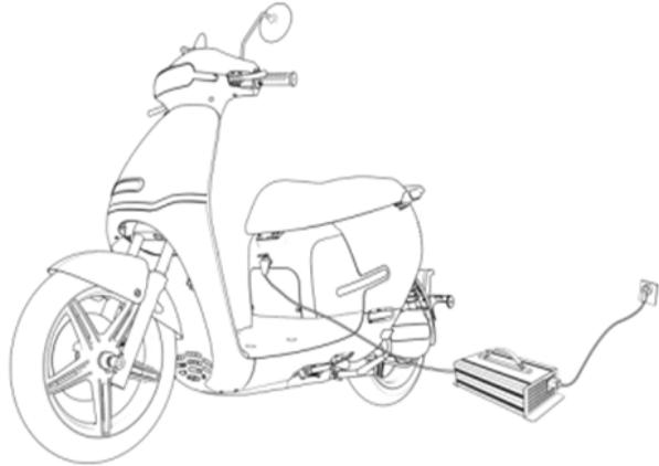
Placez la batterie dans son compartiment, branchez la prise d'alimentation du véhicule à la batterie, puis insérez la prise de charge du chargeur dans l'interface de chargement située au-dessus du marchepied pour charger le véhicule. Ensuite, le témoin du chargeur s'allume et la batterie affichera la puissance en temps réel.
