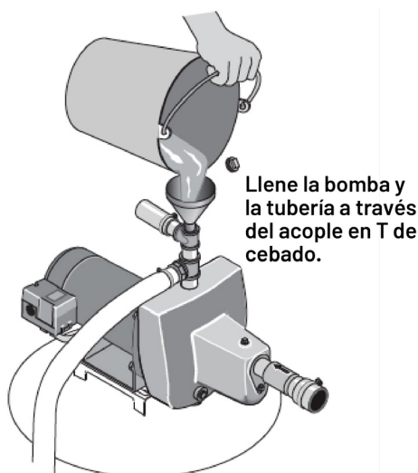
Figura 10: Cebado de la bomba
