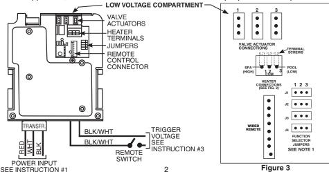
FUNCTION SELECTOR JUMPER SETTINGS: J1 MASTER SWITCH 1-2 Latching 2-3 Momentary
