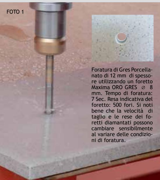
Foratura di Gres Porcellanato di 12 mm di spessore utilizzando un foretto Maxima ORO GRES  $\varnothing$  8 mm. Tempo di foratura: 7 Sec. Resa indicativa del foretto: 500 fori. Si noti bene che la velocità di taglio e le rese dei foretti diamantati possono cambiare sensibilmente al variare delle condizioni di foratura.
