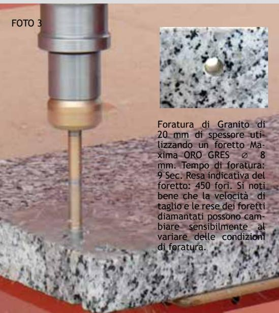
Foratura di Granito di 20 mm di spessore utilizzando un foretto Maxima ORO GRES  $\varnothing$  8 mm. Tempo di foratura: 9 Sec. Resa indicativa del foretto: 450 fori. Si noti bene che la velocità di taglio e le rese dei foretti diamantati possono cambiare sensibilmente al variare delle condizioni di foratura.
