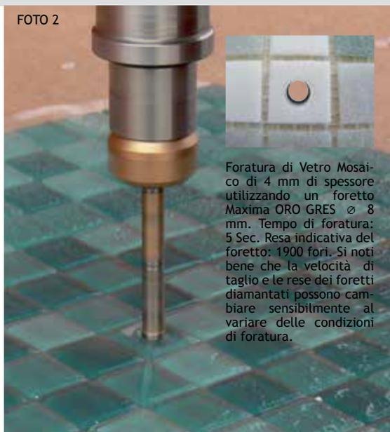
Foratura di Vetro Mosaico di 4 mm di spessore utilizzando un foretto Maxima ORO GRES  $\varnothing$  8 mm. Tempo di foratura: 5 Sec. Resa indicativa del foretto: 1900 fori. Si noti bene che la velocità di taglio e le rese dei foretti diamantati possono cambiare sensibilmente al variare delle condizioni di foratura.
