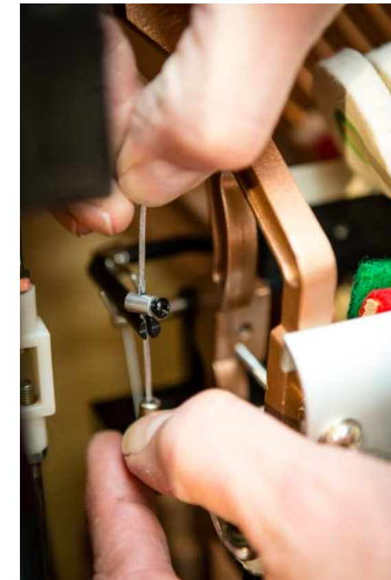
fig. 1.23: Fijnafstelling van de kabel
