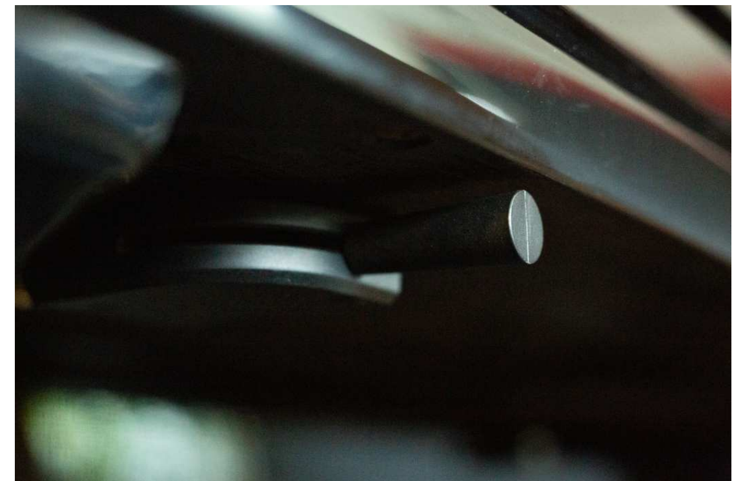
fig. 1.25: De demperhendel is gelijk met het toetsenraam wanneer overgehaald
