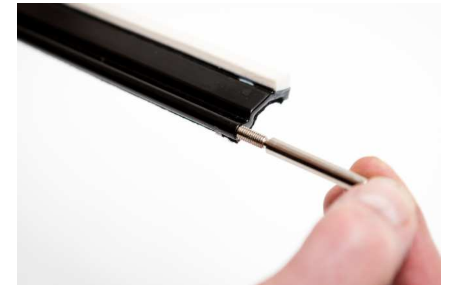
fig. 1.3: Monteer aan beide zijden een draadstang
