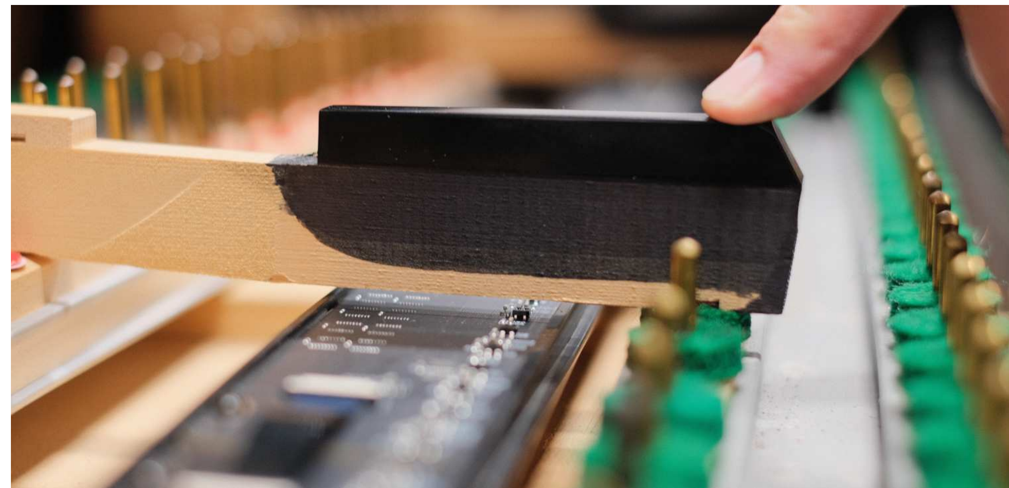
fig. 2.7: De juiste afstand tussen sensor en toets.
