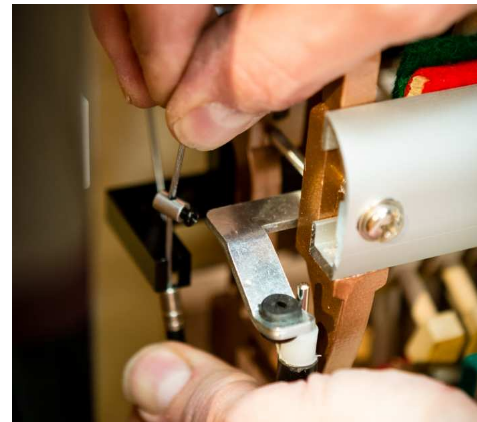
fig. 1.21: kabelhoes in L-vormige beugel
