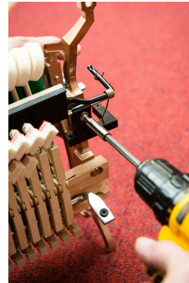
fig. 1.14: demperrail montage (baszijde)
