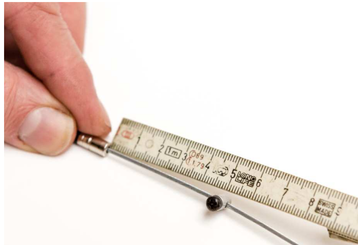
fig. 1.20: afstand van het tonnetje tot de kabelhoes
