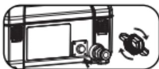
④ Schließen Sie den Wasser-Kupplungsstecker mit der Wassereinlassöffnung. Und benutzt den mitgelieferten Schraubenschlüssel, um festzuziehen. Anschließend schließen Sie die Anschlussverschraubung an Wasser-Kupplungsstecker.
