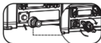
② Verbinden Sie die Schnellkupplung (weiblich) der Ausgangs-Hochdruckwasserleitung mit dem (männlich) der Wasserleitungskupplung.
