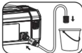
⑥ Schließen Sie das Sieb am anderen Ende des Hochdruckschlauchs an den Wassereimer an.
