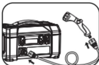
③ Verbinden Sie die Hochdruckwasserlanze mit dem anderen Ende des Hochdruckschlauchs.
