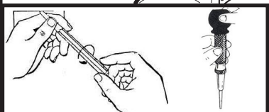
Figure 5 : En centrant la plaque dorsale, alignez-la avec les boulons en U avant et effectuer une marque sur la plaque de protection pour percer le trou de dégagement.
